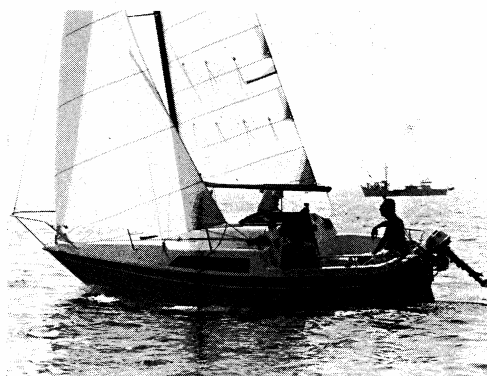
Le gènois à grand recouvrement se borde à l'intérieur des filières sur un petit rail au coin arrière du roof.
